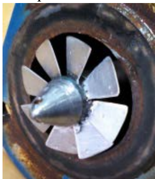
Рис. 5. Рабочее колесо, спроектированное с использованием теории Н.Е. Жуковского
