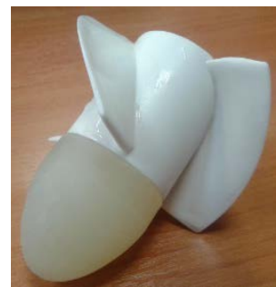
Рис. 9. Рабочее колесо, спроектированное с использованием классических подходов.
